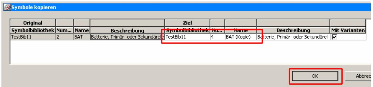
**3. Schritt** – Das kopierte Symbol öffnen. Über das Menü *Dienstprogramme – Stammdaten – Symbol – Öffnen* wird das eben kopierte Symbol geöffnet.
