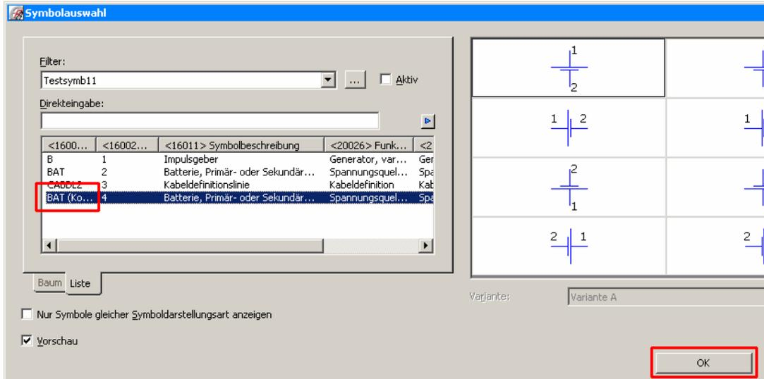
**4. Schritt** – Nach Auswahl und Übernahme mit OK kann das Symbol mit den grafischen Funktionen (Menü *Einfügen – Grafik*) bzw. über die speziellen Symbolbearbeitungsfunktionen wie im Menü *Einfügen* ersichtlich – weiter bearbeitet werden.
