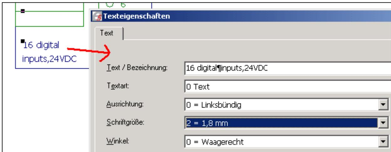
Die Kartenversorgung kann in die grafische SPS-Kartenübersicht mit eingefügt werden. Aus Platzgründen o.ä. kann die Kartenversorgung aber auch an der einzelnen EA-Ebene im Stromlaufplan oder auf einer separaten Stromlaufplanseite dargestellt werden.
