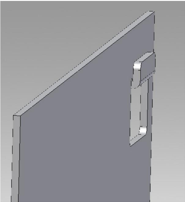
Abwicklung mit Biegelinie bei 6,69mm, Abwicklung und Biegung kann umgesetzt werden und passt im Original
