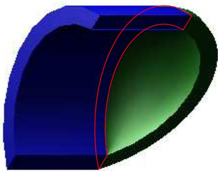
Aus der Polylinie wird eine normale Extrusion erstellt (blau)
