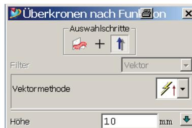
und unter „Richtung“ (*Direction*) wurde die gewünschte Verformrichtung angegeben. Der Wert bei „Höhe“ (*Height*) wurde in Millimeter eingegeben. Das Ergebnis ist ein eigenes Formelement (*Feature*), das zunächst im orangefarbenen Körper steckt. Wird der orange Ausgangskörper ausgeblendet, so erkennt man das Ergebnis der „globalen Formgebung“ (mittleres Teilbild = Oberseite, rechtes Teilbild = Unterseite).
