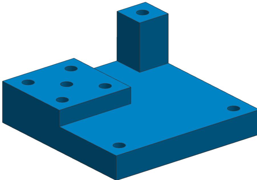
In jedem Kreismittelpunkt der Bohrungen wird ein assoziativer Punkt erstellt. Ändert man die Höhe des Teils, geht der Punkt mit, die Z-Koordinate passt sich an.
