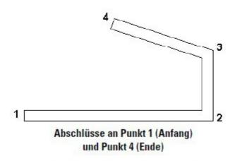
Richtung anzeigen: Zeigt die Richtung einer Wand vom Anfangs- bis zum Endpunkt an. Dies ist hilfreich, um Abschlüsse zu definieren und um verschiedenen Wandseiten Materialien zuzuweisen.
