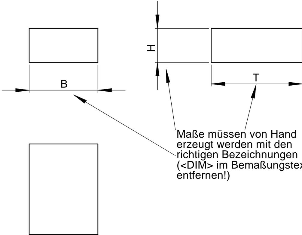
Maße müssen von Hand erzeugt werden mit den richtigen Bezeichnungen (<DIM> im Bemäßungstext entfernen!)
