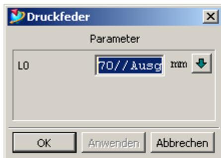
2.) Wenn dieses Fenster geschlossen wird, ohne den Parameter anzugeben, dann kann die Komponente nachträglich verformt werden. Dazu im Baugruppennavigator mit der rechten Maustaste auf die zu verformende Komponente gehen und „verformen“ anklicken.
