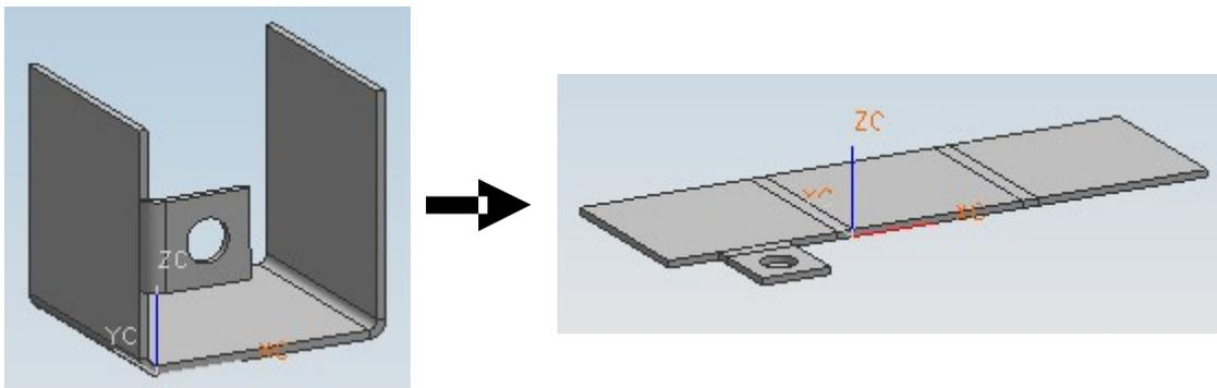
7.) **Einfügen – Blech-Formelement – Biegen rückgängig / Erneut biegen...** wählen
