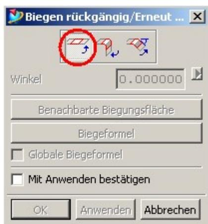
8.) Nun die **Anfangskante der ersten Biegung** auswählen und auf **Anwenden** klicken. Das selbe noch **mit der zweiten und dritten Biegung wiederholen**. Aus Gründen der Übersichtlichkeit ist es sicher sinnvoll, beim Aufheben der Biegungen die umgekehrte Reihenfolge der erzeugten Biegungen einzuhalten, ist aber nicht Bedingung.
