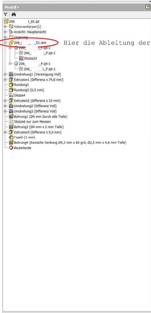
Hier die Ableitung der Baugruppe mit anschließender Bearbeitung
