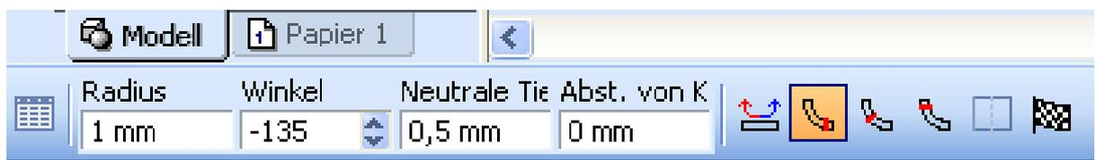
Wenn mit 3D-Objekten und „Bearbeitungshistorie erstellen“ gearbeitet wurde, kann über die „Auswahl“ jeder Biegeradius geändert werden.
