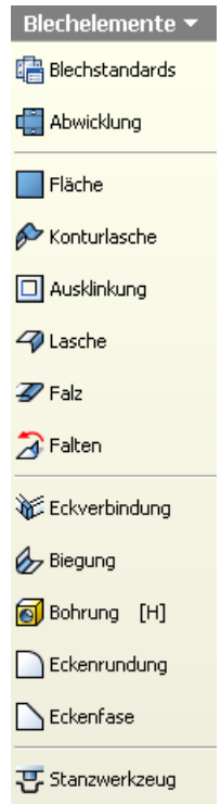
Bild 3: Hauptfunktionen der Inventor-Blechkonstruktion
