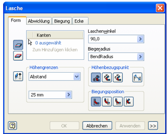
Bild 10: Erzeugung einer Basisfläche mit einer Lasche (oben) oder mehrerer Lasche gleichzeitig (unten)
