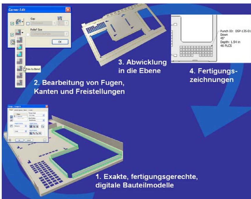
Bild 2: Grundsätzlicher Ablauf der 3D-Blechkonstruktion
