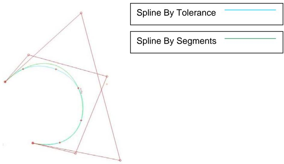
Beide Spline wurden durch die gleichen Punkte erzeugt
