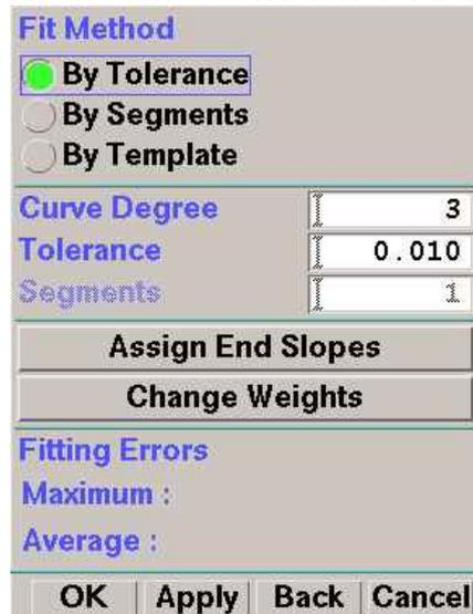
**By Tolerance:** Hier wird die Toleranz zu den spezifizierten Punkten gewählt
