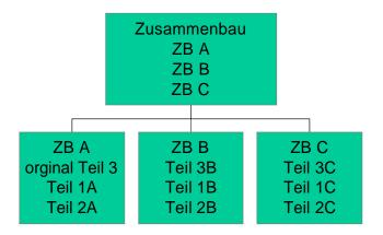
Teile 3A,3B werden falsch geladen, wenn ZB C erster eingefügter ZB ist
