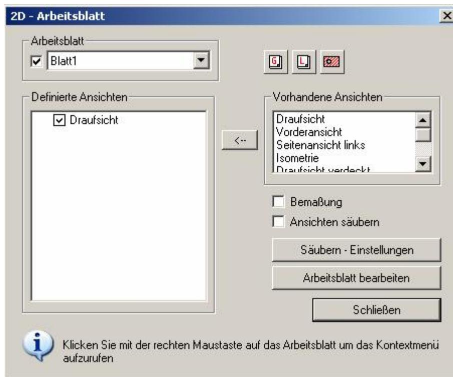
Ein 2D-Arbeitsblatt wird mit der Vergabe eines Namens eindeutig bestimmt. Auf diesem 2D-Arbeitsblatt werden im 2D-Modus vordefinierte Ansichten platziert, die bei Änderungen in der 3D-Konstruktion automatisch oder auf Anforderung angepasst werden. Die zu platzierenden Ansichten sind von vorhandenen Ansichten übernehmbar oder neu bestimmt. Diesen Ansichten sind Attribute wie z.B. Hiddenline, Layer und Gruppen ein- ausschalten und Schnittdarstellung zuordbar.
