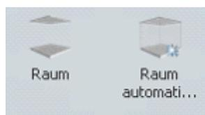
3.) jetzt wird mit dem Werkzeug Raum (Werkzeugpalette/Gestaltung/Bauteile) und nicht mit „Raum automatisch erzeugen“ ein
