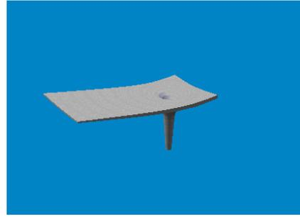
Schieben Sie den Quader an die gewünschte Position und führen Sie Die Operation Schnittmenge aus. Der Boolesche Körper soll hierbei gelöscht werden.
