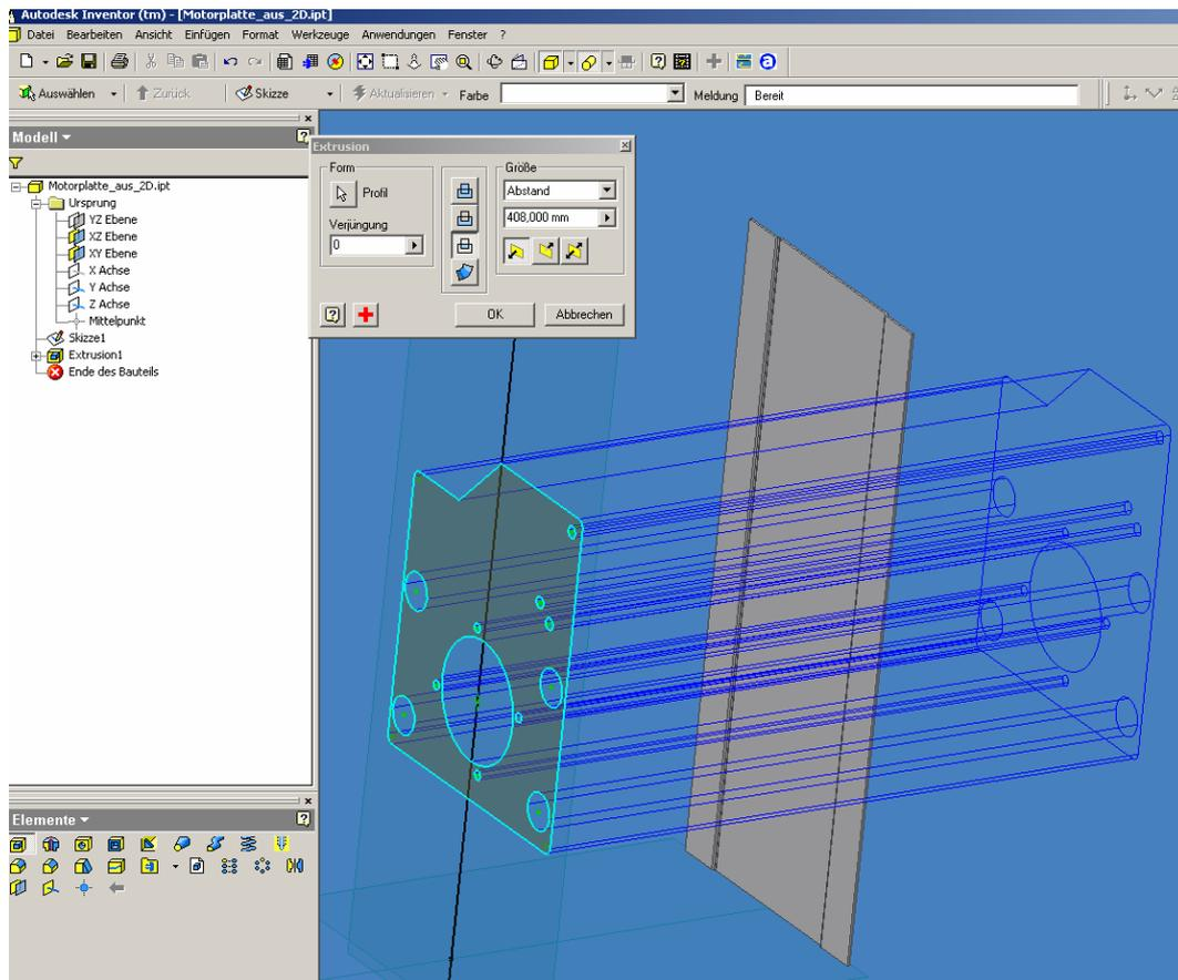
Bei dieser 2ten **Extrusion** wird der **Typ „Schnittmenge“** gewählt. Das Ergebnis ist das 3D-Modell des gewünschten Bauteils.
