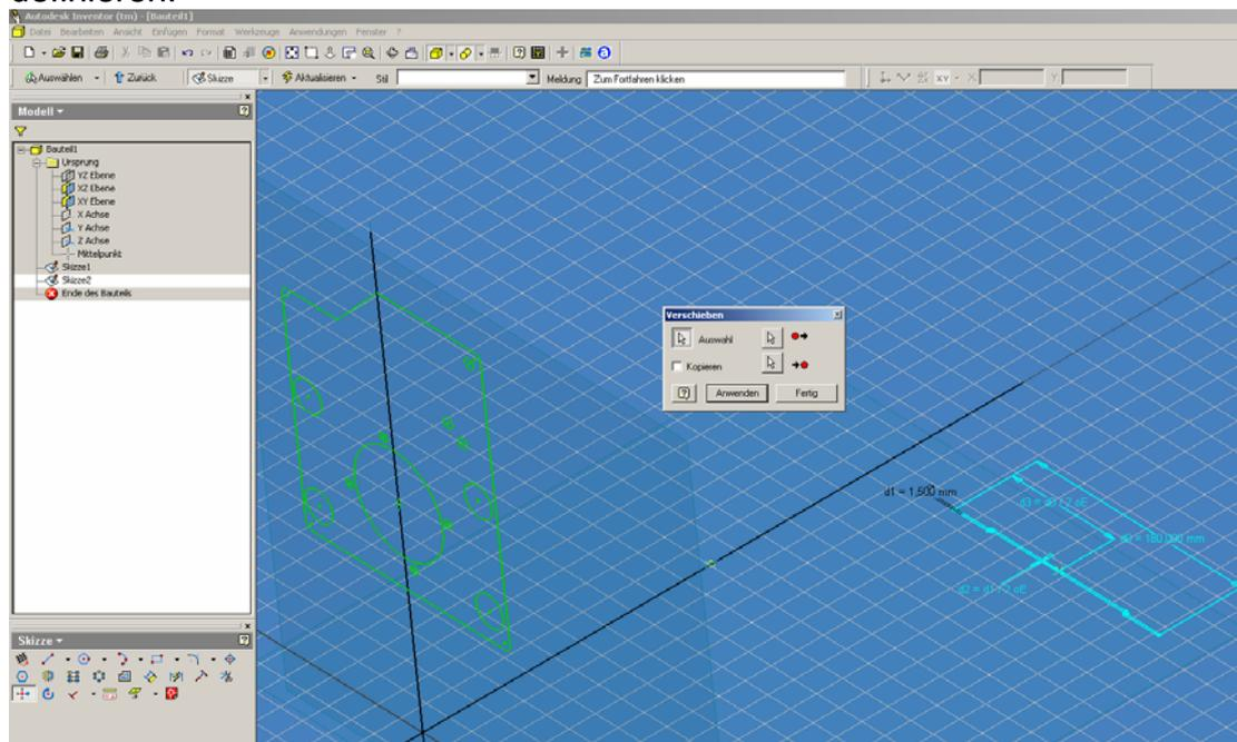
Beide Skizzen über Skizzenanalyse auf Fehler (offene Kontur ist ausreichend...) prüfen lassen, evt. nachbessern.
