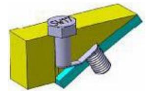
Federschraube für flächige, versetzte Winkelverschraubungen
