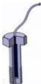
Sonderschraube mit Vorbereitung für eine Notsprengung
