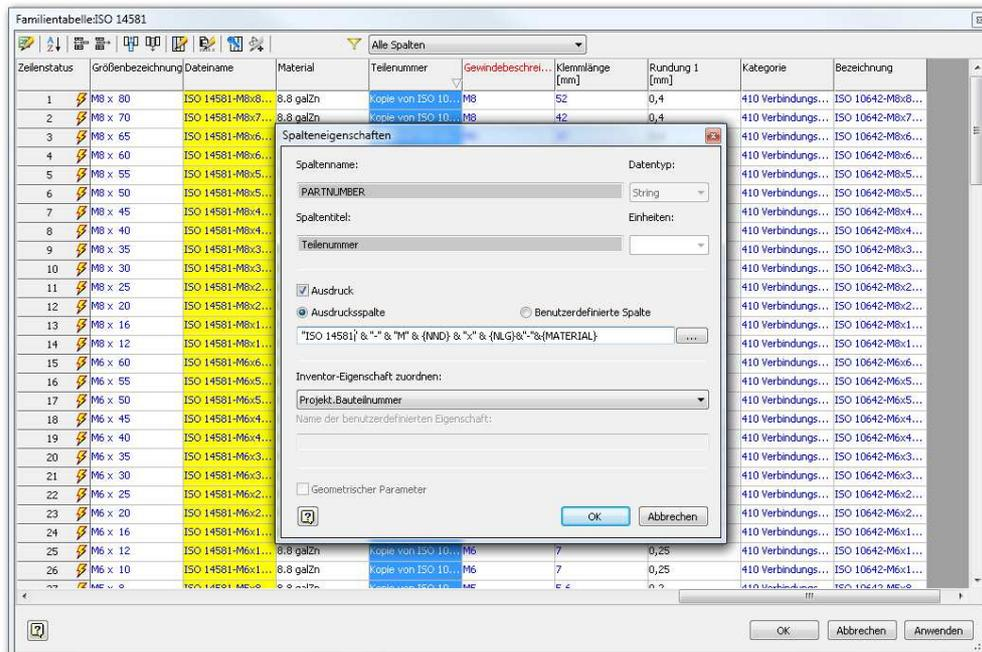
So, jetzt kannst Du die Schraube schon einsetzen, solange Dich nicht stört, das im Modell weiterhin der I6kt-dargestellt wird..... Stücklistenmäßig ist alles OK => Der Rest ist Schönheit der Arbeit.
