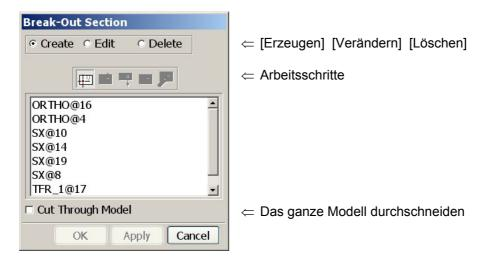
Der Basispunkt bestimmt die Tiefe des Ausbruchs, der Vektor für die Materialwegnahme die Richtung, in der Material entfernt wird. Die Begrenzungslinien müssen einen ununterbrochenen Linienzug bilden und mit der Ansicht verbunden sein.
