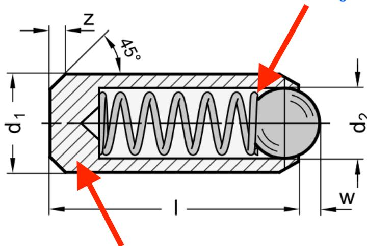
Statt das Gehäuse in eine Bohrung einzulassen, sollen Feder und Kugel direkt in eine passende Bohrung eingelassen werden. So kann die Bohrtiefe reduziert werden
