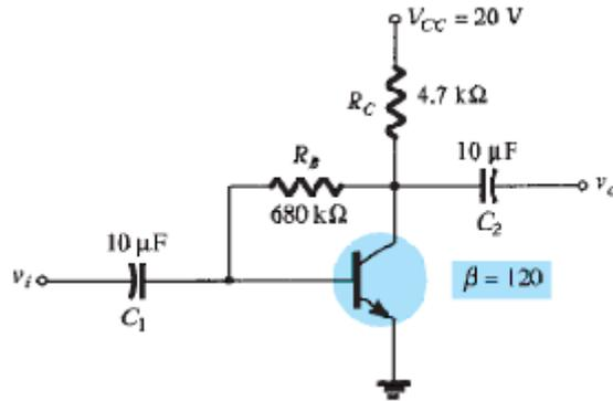
$$R_B := 680\text{k}\Omega \quad R_C := 4.7\text{k}\Omega \quad U_{CC} := 20\text{V} \quad \beta := 120 \quad U_{BE} := 0.7\text{V}$$
