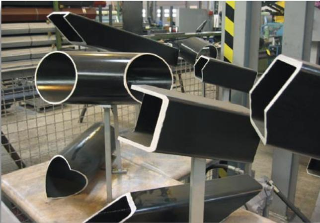
Maschinen ermöglichen u.a. präzise Schrägschnitte nach gewünschten Längenangaben.
